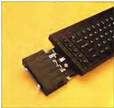
L'interfaccia si inserisce nello slot di espansione posto nel lato sinistro del computer.
